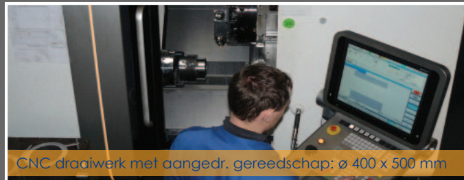
CNC draaiwerk - 2 machines: \varnothing 760 / \varnothing 460 x 2000 mm
